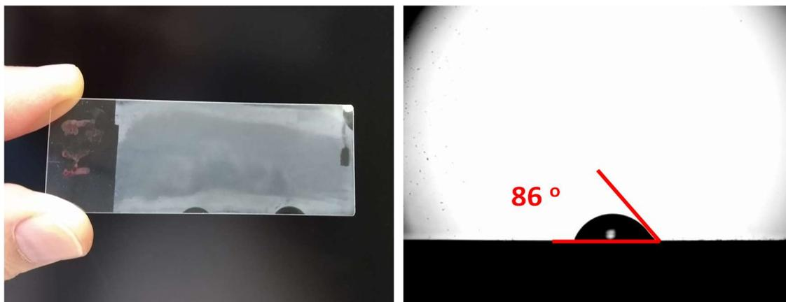
**Figura 44:** Imagem do filme de COF-1 e de ensaio de gota da amostra A1-a.
