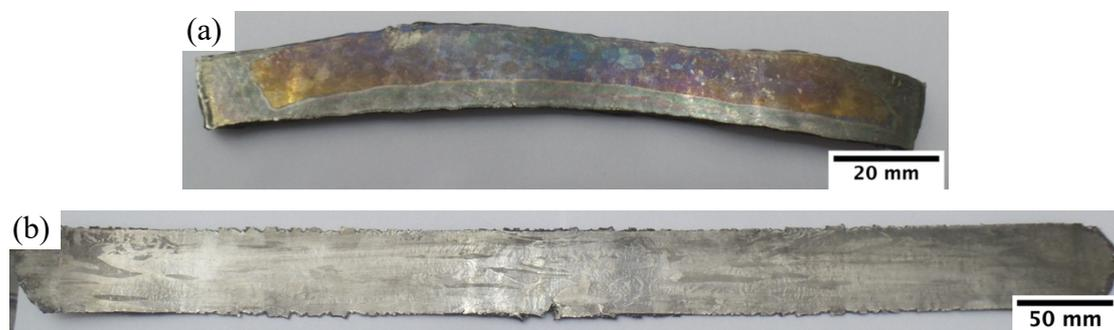
**Figura 4.10** – Imagem de amostras da liga piloto Ti-23,6Nb-5,1Mo-6,7Zr após processo de laminação a frio com (a) 50 % e (b) 90 % de redução.
