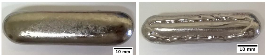
**Figura 3.4** – Lingote e duas faces da liga Ti-29Nb-2Mo-6Zr após a fusão.
