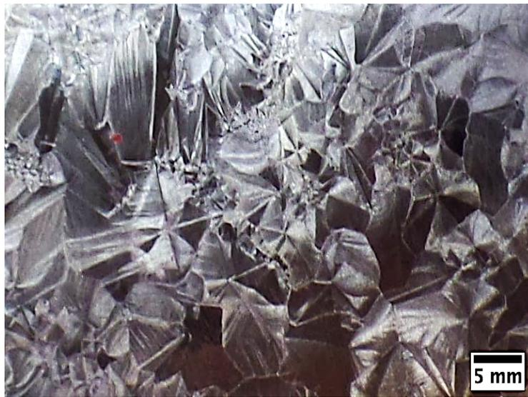
**Figura 4.5** – Macrografia da seção transversal da superfície do lingote produzido por feixe de elétrons após 3 refusões (posição central). Não foram observados defeitos de fundição. Sem ataque.
