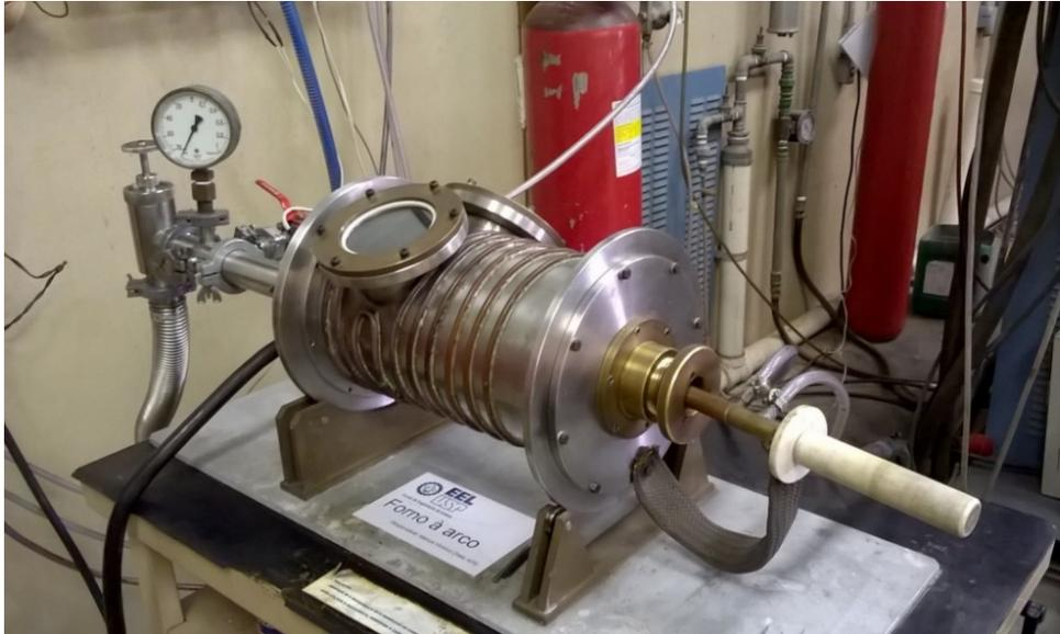
**Figura 3.3** – Forno de fusão a arco utilizado para a preparação dos lingotes (Laboratório de fusão e tratamentos térmicos da EEL/USP).
