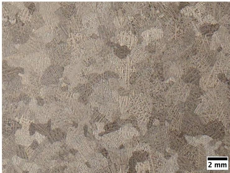
**Figura 4.3** – Macrografia transversal da superfície superior do lingote fundido no VAR (posição central). Não foram observados defeitos de fundição, mas uma estrutura dendrítica. Sem ataque.
