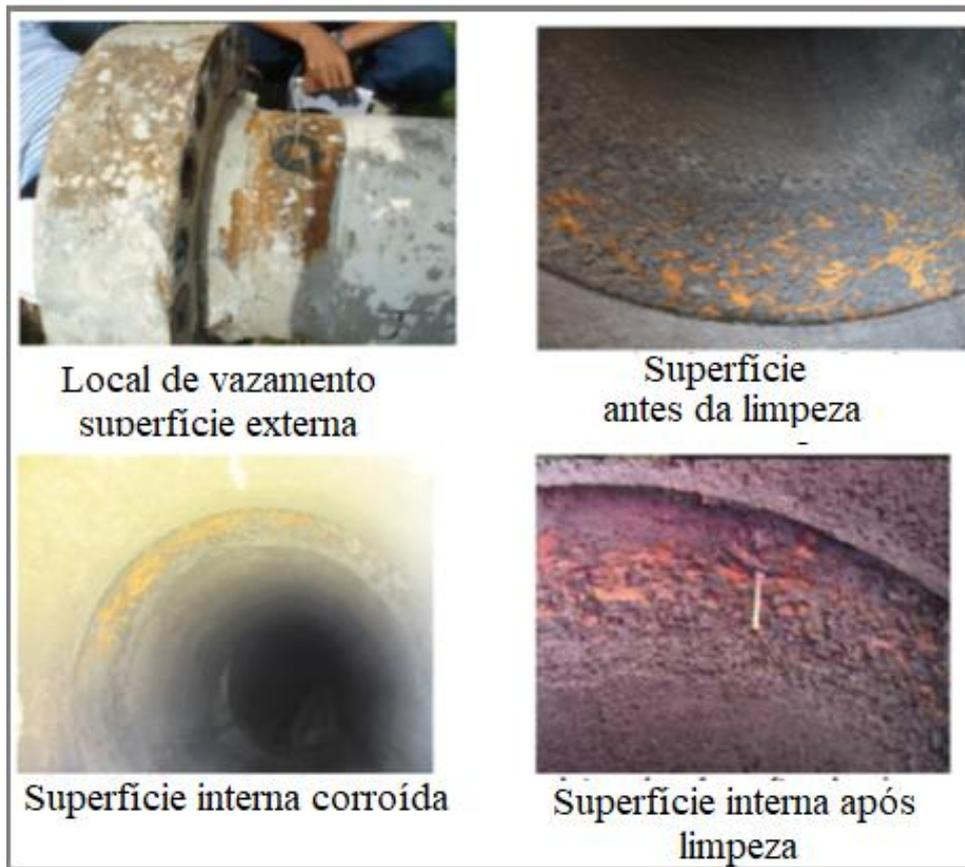
**Figura 5: Área corroída em torno do vazamento próximo ao flange.**
