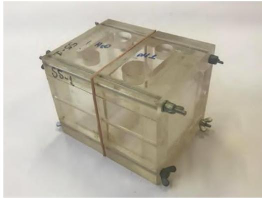
**Figura 30:** Célula utilizada para medidas de permeabilidade do íon  $H^+$  através do filme livre do revestimento.
