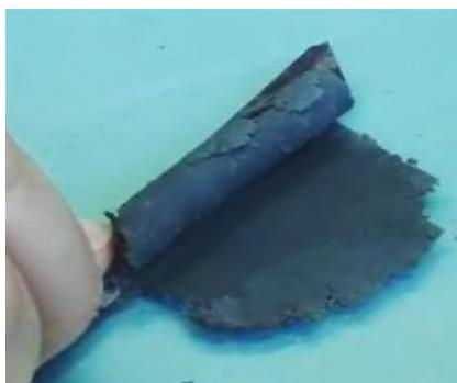
**Figura 28:** Ponto de “rocambolé” durante ensaio de absorção de óleo de linhaça pelas argilas.
