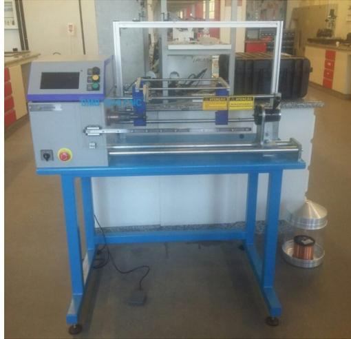
Figura 5.38: Bobinadeira CNC para fabricação das sondas.
