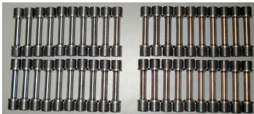
**Figura 4.4.2 – Corpos de prova destinados aos ensaios de fluência**
