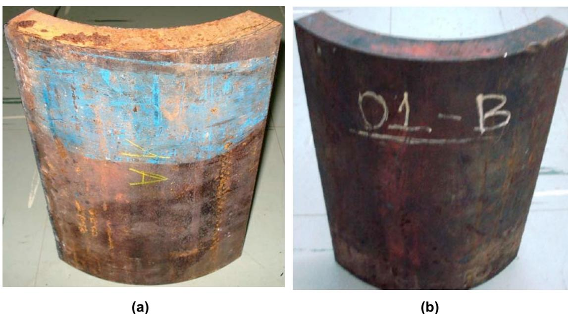
**Figura 4.1.1 – Seguimentos de tubos de aço 2,25Cr-1Mo como recebidos, apresentando as microestruturas: (a) ferrita-bainita e (b) ferrita-perlita**
