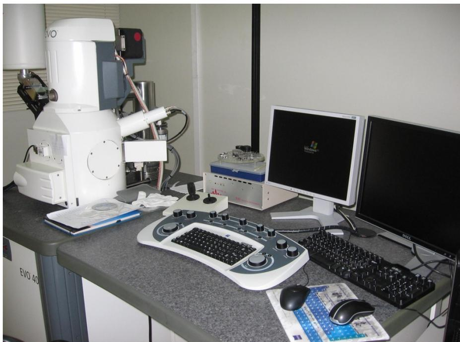
**Figura 4.7.1 – Microscópio eletrônico de varredura do Cepel**
