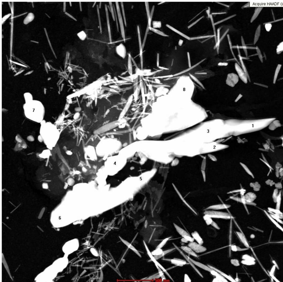
Figura 5.5.5.7 – Análises pontuais de EDS na amostra P-08: precipitados do tipo  $M_6C$  (ponto 1, 2, 4), precipitados do tipo  $M_7C_3$  (pontos 3, 5, 6), precipitados do tipo  $M_{23}C_6$  (pontos 7, 8)
