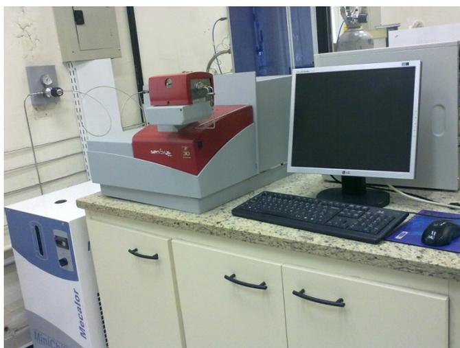
Figura 33. DSC Setaram Sensys Evo DSC.
