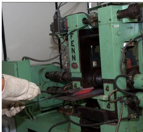
Figura 27. Laminador FENN 150, disponível no Laboratório TERMIC.
