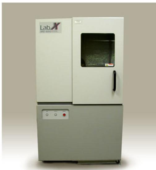
Figura 32. Difratorômetro Shimadzu modelo XRD-6000.
