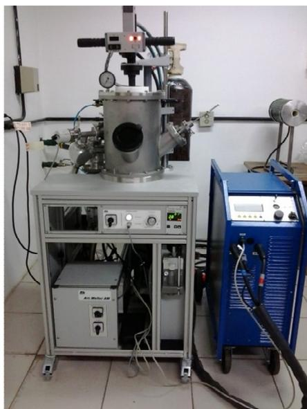
Figura 23. Forno elétrico a arco Bühler AM-VARIO 400.
