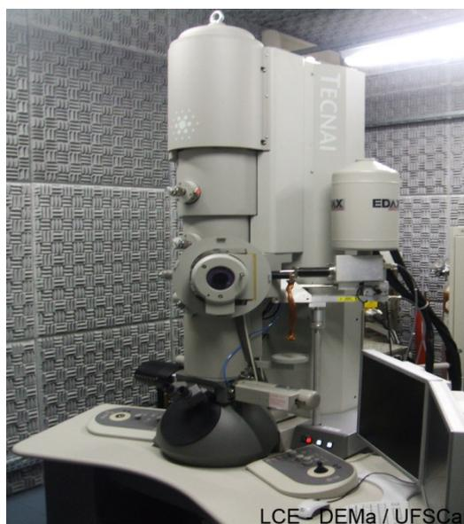
Figura 34. Microscópio eletrônico de transmissão FEI TECNAI G<sup>2</sup>F20.
