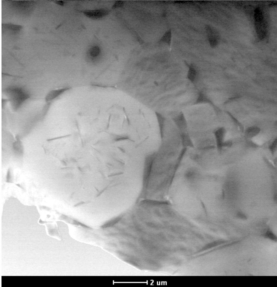
Figura 50. Observação por MET em liga Zr-Nb-Cu mostrando microestrutura contendo precipitados no interior e no contorno de grão.
