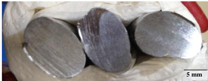
Figura 25. Seção transversal dos lingotes mostrando a eficácia da fusão a arco.
