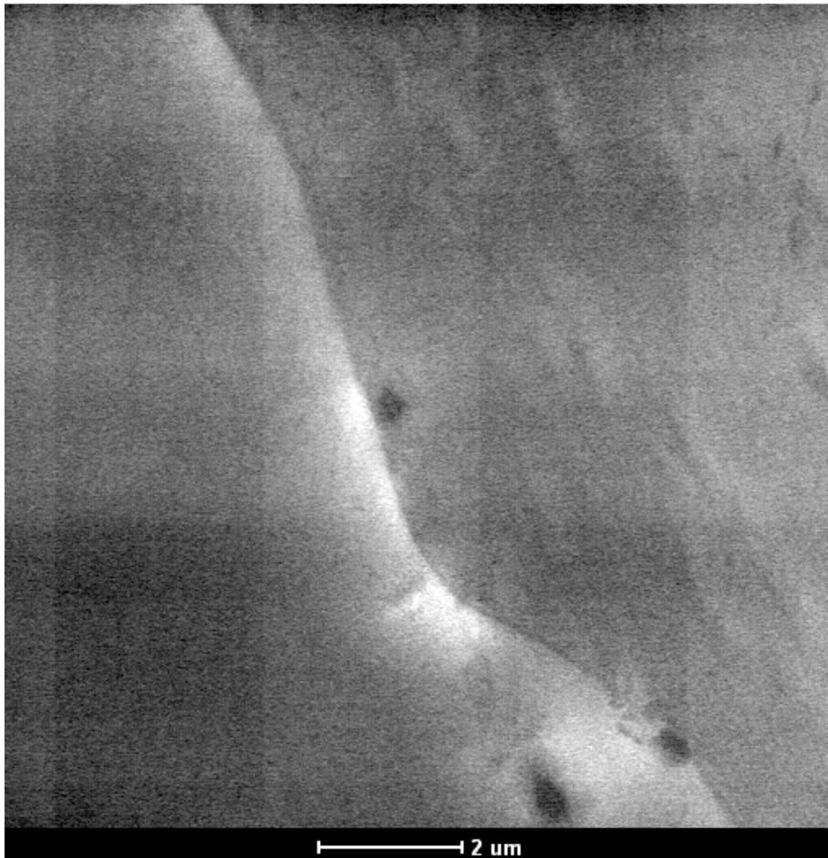
Figura 46. Observação por MET em liga Zr-Nb-Al mostrando microestrutura contendo precipitados próximos ao contorno de grão.
