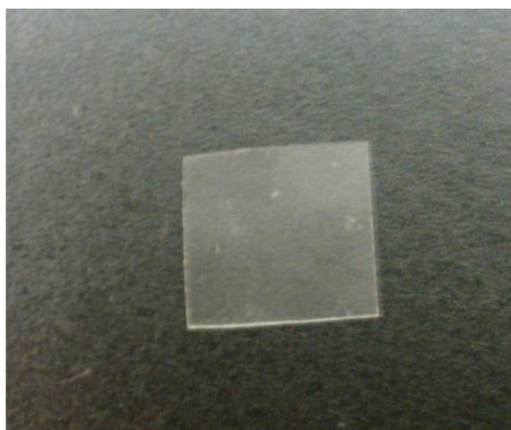
Figura 16 – Filme de amido de milho obtido pela técnica de evaporação de solvente (1,5 x 1,5 cm<sup>2</sup>).
