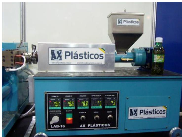
Figura 12 – Extrusora utilizada na preparação dos filmes.
