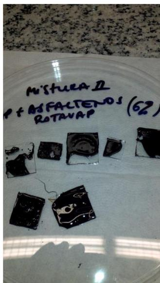
Figura 25 – Placas de vidro recobertas com Mistura 2 para posterior análise no AFM.
