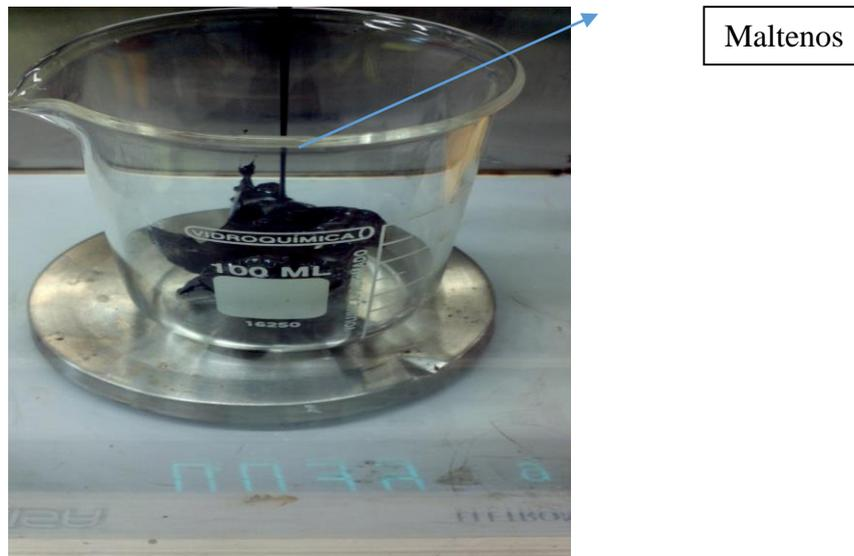
Figura 26 – Maltenos (óleo) sendo adicionado ao CAP 30/45 para posterior mistura realizada nas dependências do PEMM/COPPE/UFRJ.
