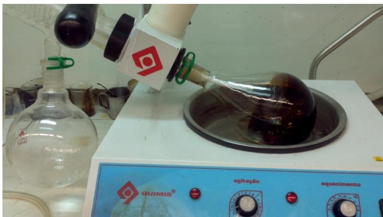
Figura 37 – Separação do solvente heptano dos maltenos realizada nas instalações do PEMM/COPPE/UFRJ.
