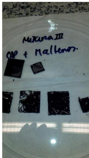
Figura 27 – Placas de vidro recobertas com Mistura 3 para posterior análise no AFM.
