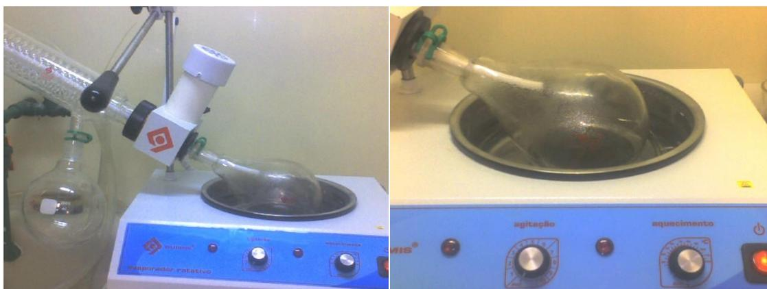
Figura 22 - Evaporador Rotatório utilizado no procedimento de separação
