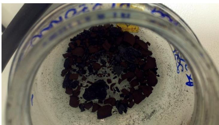
Figura 36 – Asfaltenos obtidos por extrações por solvente Heptol e submetido à extração de solvente por evaporador rotatório. Asfaltenos com aparência opaca e granular. Realizada nas dependências do PEMM/COPPE/UFRJ.
