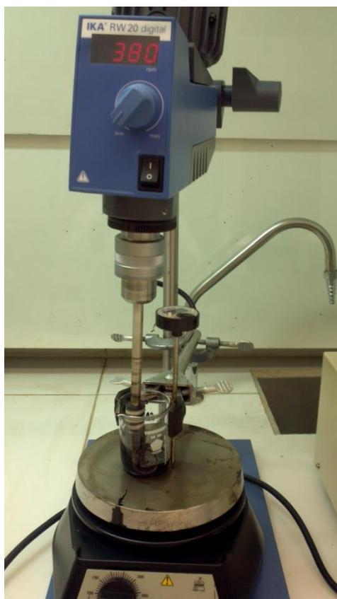
Figura 23 – Mistura das frações fundamentais e CAP 30/45 realizada nas dependências do PEMM/COPPE/UFRJ.
