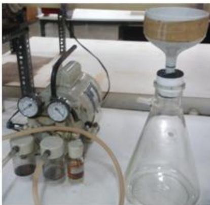
**Figura 4.1- Filtração a vácuo.**
