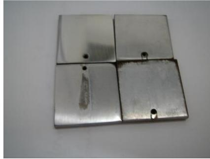
**Figura 5.25:** Imagens Fotográficas dos CPs utilizados no MEV, CP polido (superior esquerdo), CP Branco (superior e inferior direito) e CP imerso em solução neutra com 2% de extrato concentrado de bagaço de uva (inferior esquerdo).
