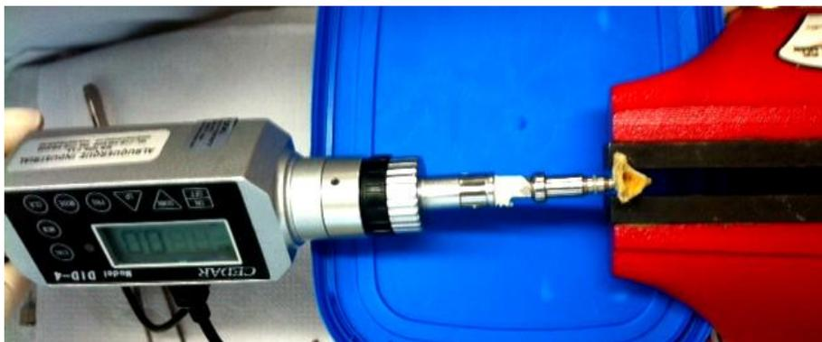
Figura 4.5- Posicionamento do torquímetro ao implante
