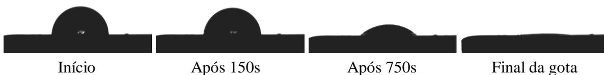
Figura 5.19- Evolução do molhamento na superfície anodizada com gota de água destilada (900s).
