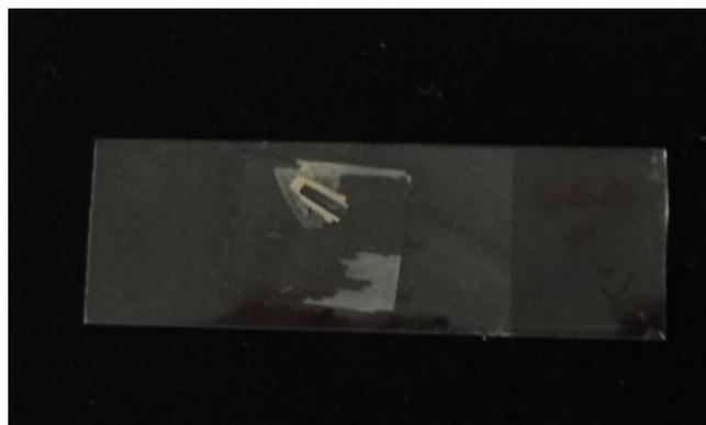
Figura 4.10- Amostra lixada e fixada em placa de vidro, pronta para análise histomorfométrica.
