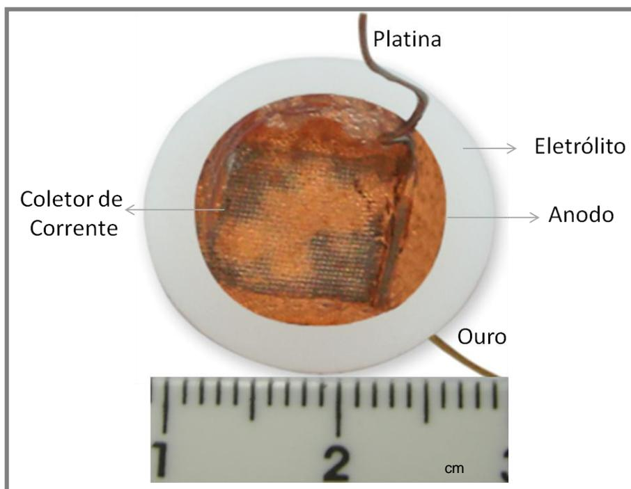
Figura 101: Fotografia do anodo Cu-(CeO<sub>2</sub>-Al<sub>2</sub>O<sub>3</sub>)-(CeO<sub>2</sub>-Al<sub>2</sub>O<sub>3</sub>-ZEI) após operação da PaCOS a 750 °C em atmosfera de C<sub>2</sub>H<sub>5</sub>OH puro.
