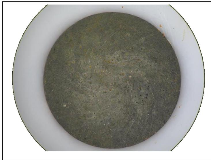
Figura 19: Presença de pites sobre a superfície do ferro após a polarização.
