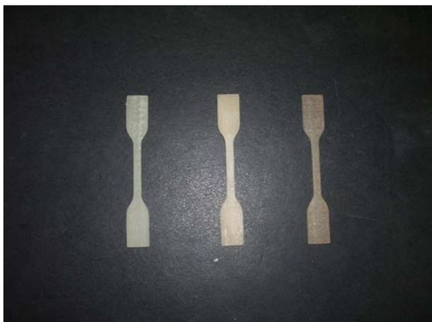
**Figura 3.3:** Corpos de prova dos compósitos obtidos por extrusão: compósito A (0 % de fibra); compósito B (1% de fibra) e compósito C (10% de fibra), respectivamente.
