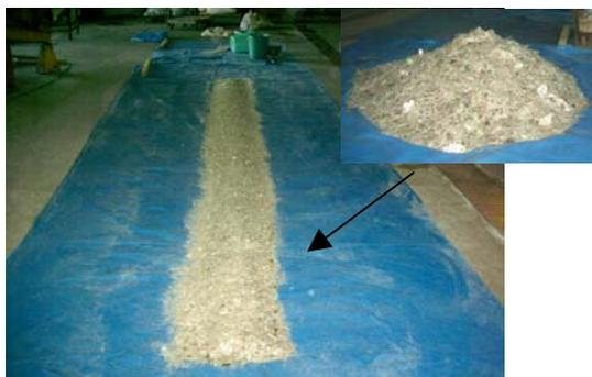
**Figura 28** – Pilha cônica para homogeneização da amostra de muscovita.
