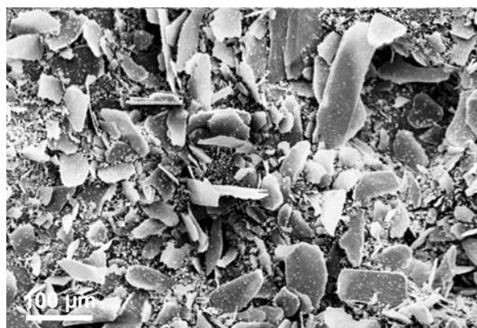
**Figura 55** – Imagem de microscopia eletrônica de varredura do pigmento mica+PrO<sub>2</sub> exibindo excesso de óxido não adsorvido.
