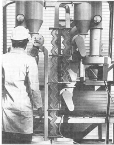
**Figura 7** – Concentrador zig-zag utilizado no método pneumático (JORDAN *et al.*, 1980)
