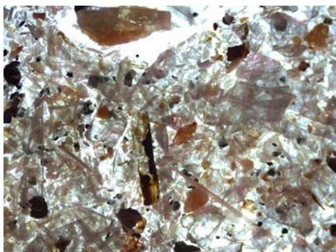
**Figura 42** – Imagem do rejeito do processo de concentração por mesagem. Microscopia óptica, 8 X de aumento.
