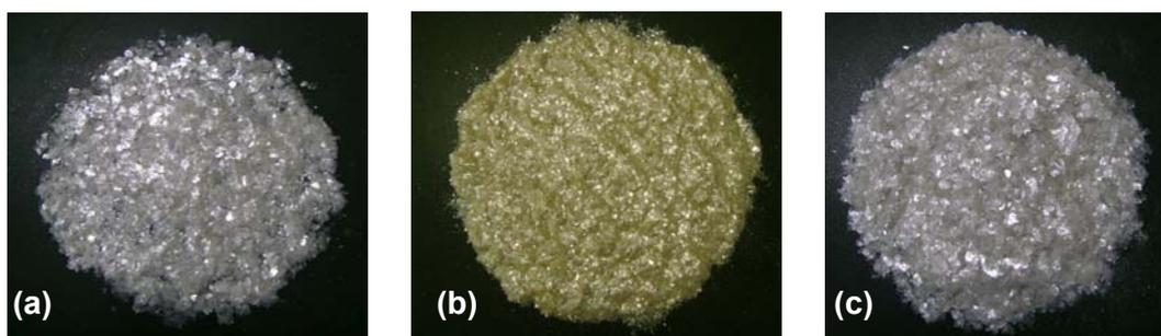
**Figura 36** – Aspecto visual da mica moída em moinho de martelos (a), barras (b) e facas (c).
