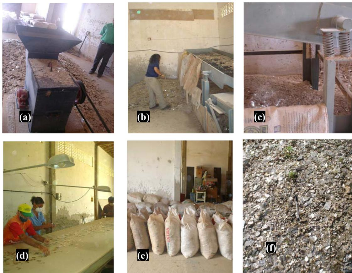
**Figura 26** – Desplacador de mica (a), mica deslocada sendo alimentada na peneira (b), rejeito de mica (-15 mm) (c), cata  o manual das impurezas da mica (d), sacos de r fia contendo mica (e), pilha de rejeito de mica (f)
