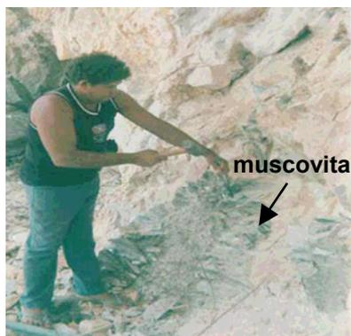
**Figura 4** – Lavra de muscovita com uso de ferramentas convencionais na mina Ubaeira (RN), (LUZ *et al.*, 2005).
