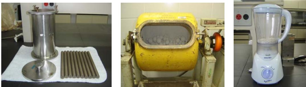
**Figura 43** – Moinhos de barras (a), de bolas (b) e de facas adaptado (c) utilizados para moagem secundária.
