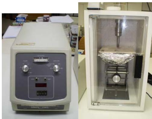
**Figura 18** – Aparelho de ultrassom de ponteira (*Sonics and Materials*).
