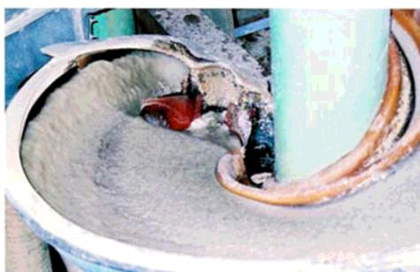
**Figura 5** – Exemplo de concentração de minério em espirais de Humphreys, (LUZ *et al.*, 2005)
