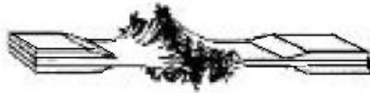
Figura 2.9: Falha tipo explosão.
