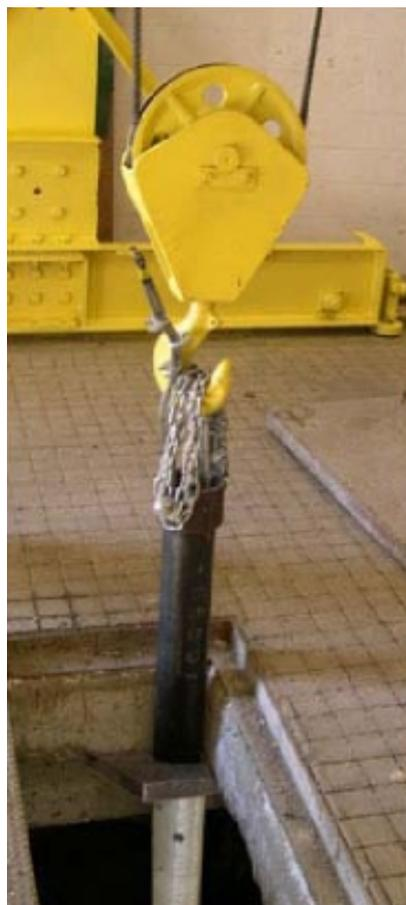
Figura 5.17: Extração do tubo de compósito com auxílio de uma talha.
