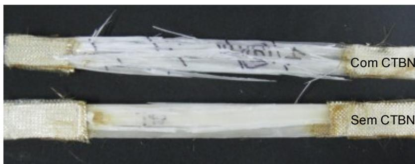
Figura 5.14: Corpos-de-prova dos laminados com e sem CTBN pós ensaio de tração.
