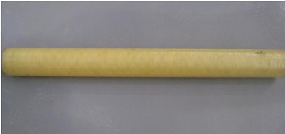
Figura 5.18: Tubo de compósito processado no mandril colapsável.
