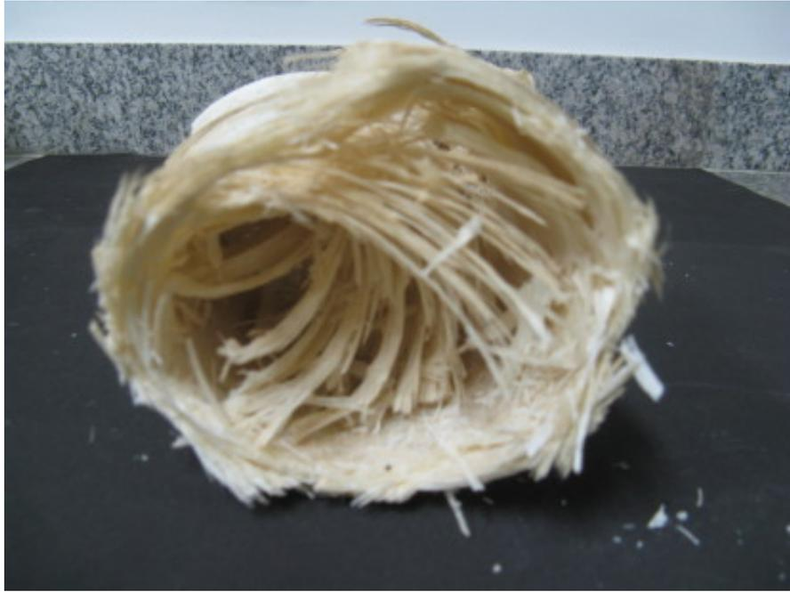
Figura 5.34: Visão lateral da região interna do tubo com 16 camadas.
