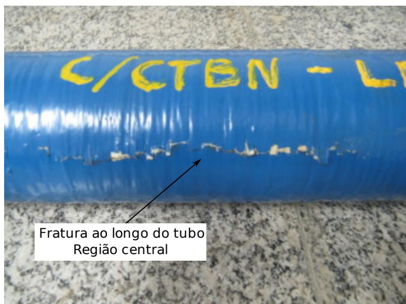
Figura 5.30: Parte externa da região de fratura característica dos tubos com CTBN.
