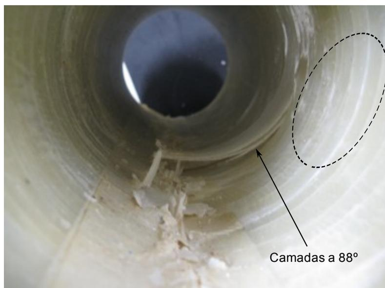
Figura 5.31: Parte interna da região de fratura característica dos tubos com CTBN.
