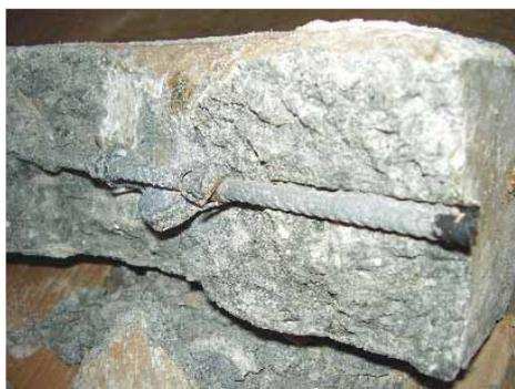
Figura 75: Exposição do aço da amostra de campo para análise visual
