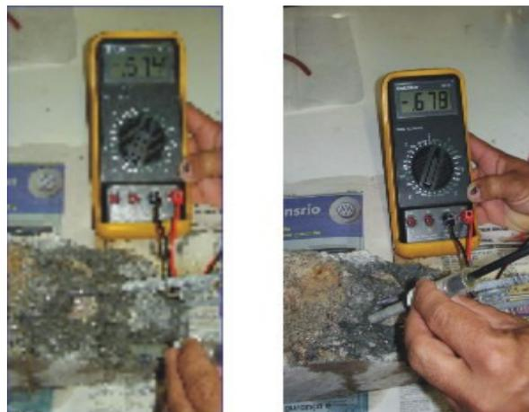
Figura 76: Medida de potencial do aço da amostra Tipo IV
