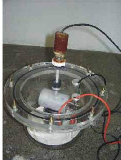
Figura 30: Célula eletroquímica para obtenção de curvas de polarização de amostras sólidas
