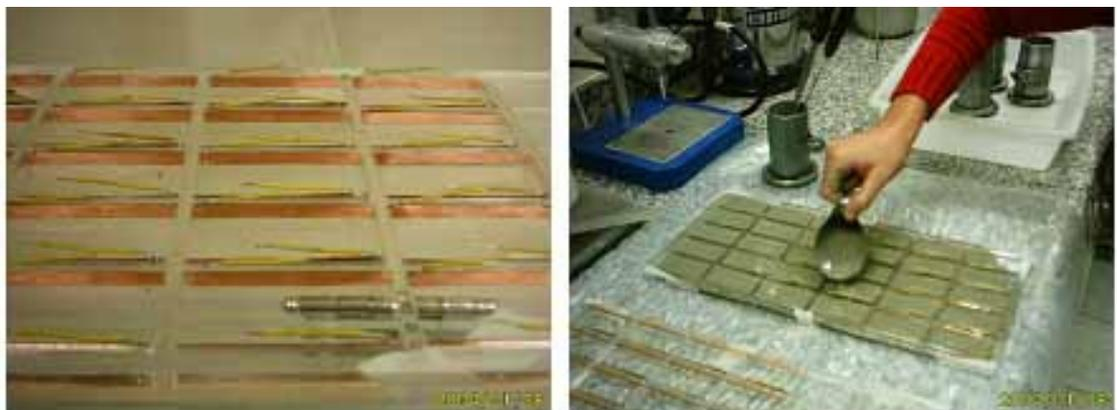
Figura 23– Forma de acrílico para moldagem das amostras e lançamento da pasta
