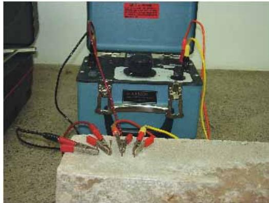
Figura 74: Medida de Resistividade da amostra exposta de campo pelo método de Wenner.
