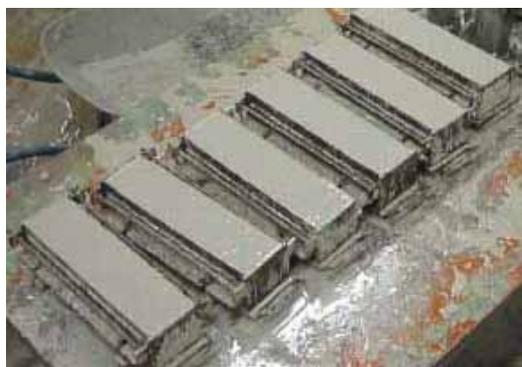
Figura 26: Prismas de concreto armado para exposição em ambientes externos
