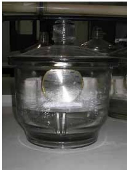
Figura 27 – Dessecador com umidade relativa controlada
