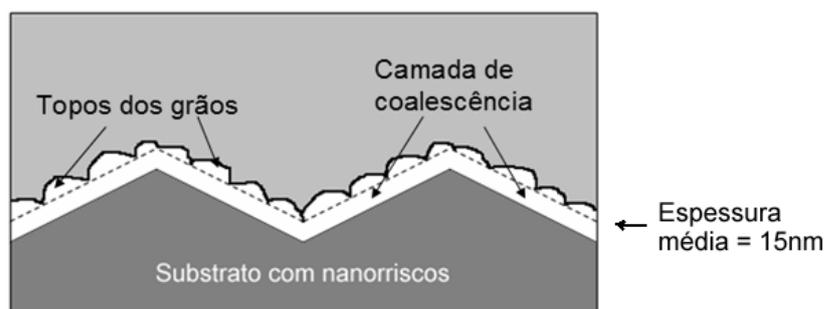
**Figura 4.26:** Esquema idealizado de um filme fino de permalloy, com 15 nm de espessura, com grãos semielipsoidais coalescentes, exibindo a camada contínua de material que se forma por baixo dos topos dos grãos.
