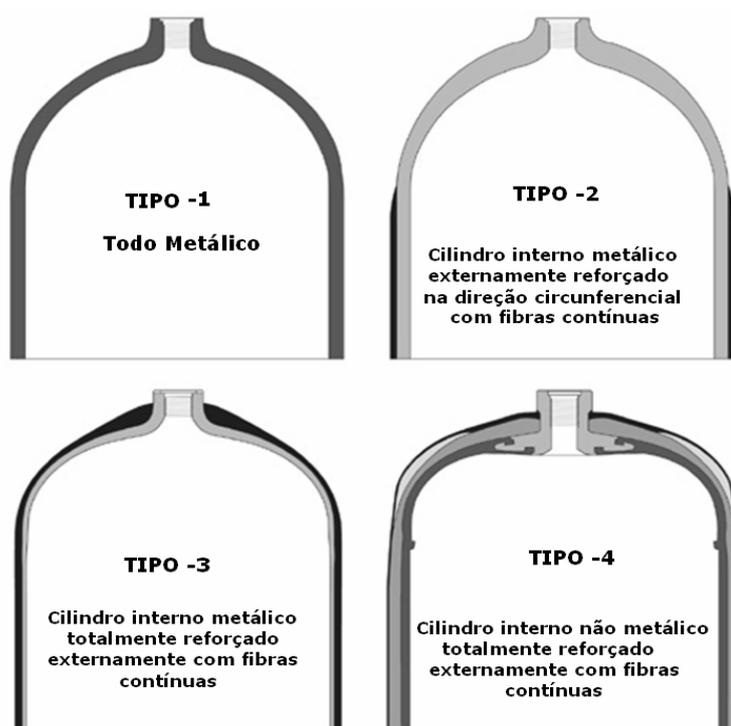
**FIGURA 7.** Tipos de recipientes para o armazenamento do hidrogênio comprimido segundo a EIHP. (Adaptado de ZIEGER, 2002).
