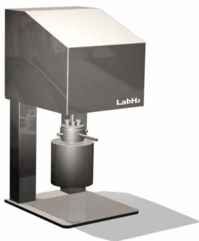
**FIGURA 123.** Desenho esquemático do novo equipamento de Sievert automatizado, para a determinação das propriedades relativas ao hidrogênio.
