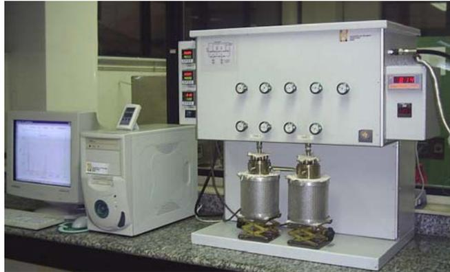
**FIGURA 38.** Equipamento de Sievert utilizado para medir as propriedades relativas ao hidrogênio.
