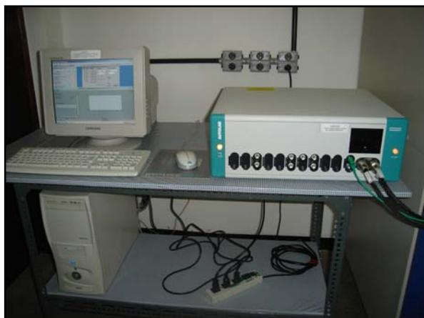
**Figura 29:** Imagem do conjunto AUTOLAB + computador utilizado nos ensaios de polarização e impedância.
