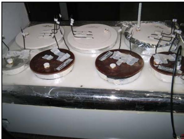
**Figura 28:** Fotografia do conjunto banho-maria + cubas com corpos-de-prova utilizados nos ensaios de imersão total.
