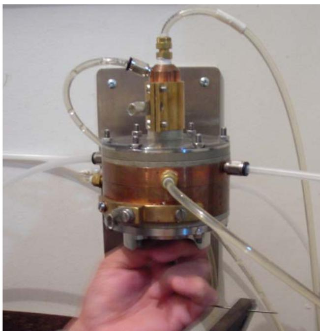
Figura 30 – Fotografia da parte superior do reator, detalhe: arame de aço para abertura do arco elétrico via curto-circuito entre os eletrodos.
