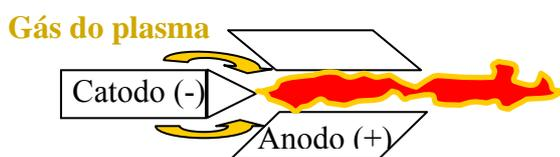
Figura 27 – Ilustração da configuração de um arco não-transferido.
