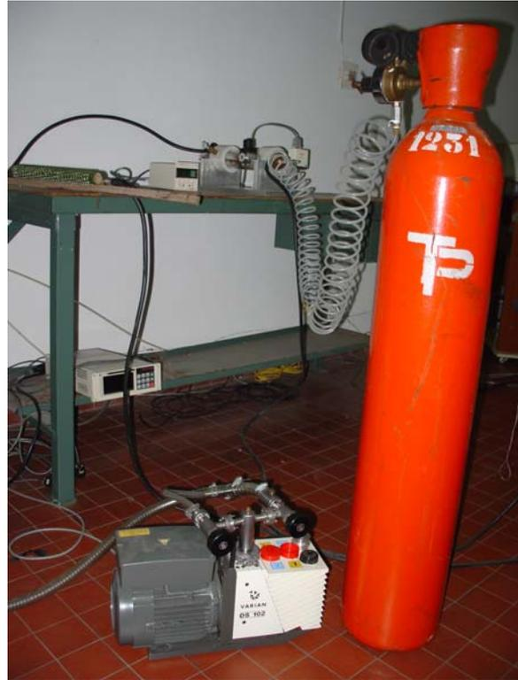
Figura 18 – Vista parcial da bancada de testes - câmara, medidor de vácuo, bomba de vácuo, cilindro de gás e acessórios.
