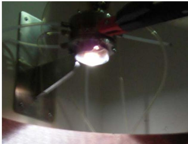
Figura 44 – Fotografia da descarga a arco elétrico de plasma formado a partir do gás argônio
