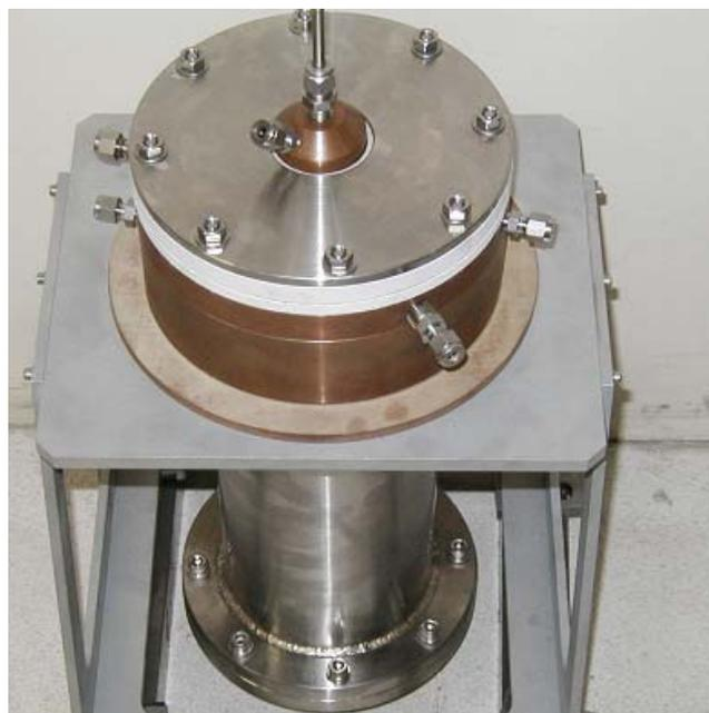
Fotografia D2 – Reator a plasma em escala piloto
