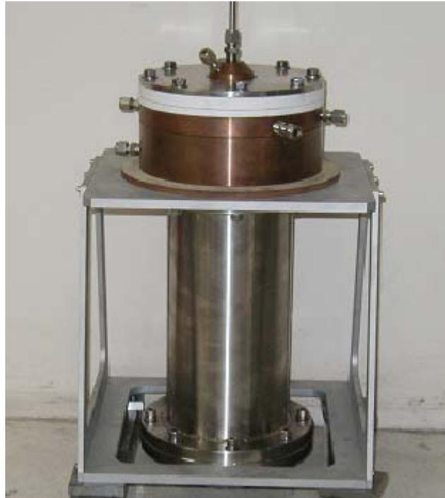
Fotografia D1 – Reator a plasma em escala piloto
