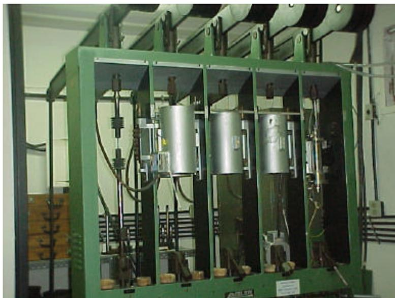
Figura 3.8 – Vista geral da máquina de ensaios de fluência Amsler localizada na COPPE/UFRJ.
