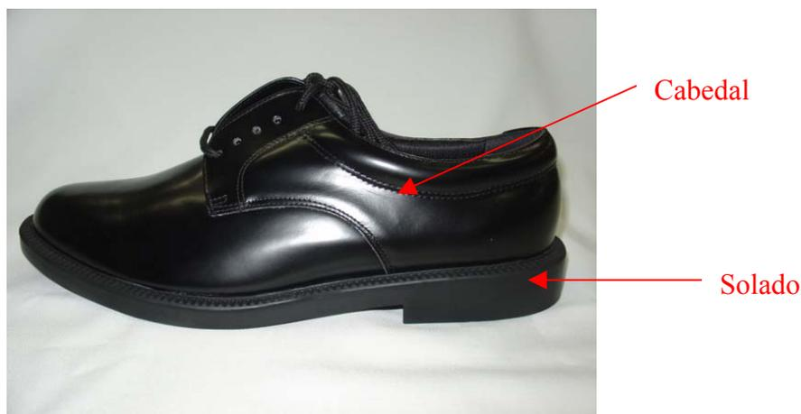
Figura 1 – Sapato preto masculino, em conformidade com a Norma MAR 71000/170E, ao ser recebido.
