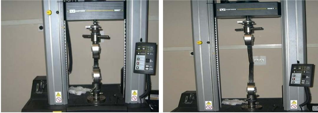
Figura 33 – Dispositivo de ensaio mecânico de resistência ao descascamento (a) no início do teste e (b) ao final do teste.
