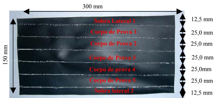
Figura 32 – Painel adesivo subdividido nos corpos de prova utilizados nos ensaios mecânicos de resistência ao descascamento.
