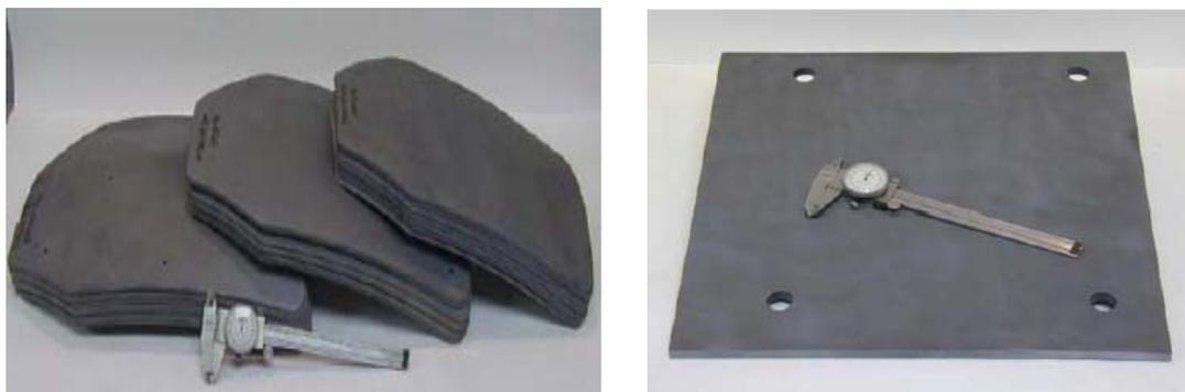
Figura 1.4 – Novas blindagens (placa de colete e piso de aeronave) obtidas através de sinterização reativa [8].
