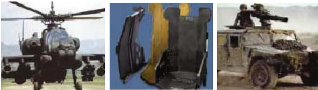
Figura 1.2 – Emprego do B<sub>4</sub>C como blindagem cerâmica [6].
