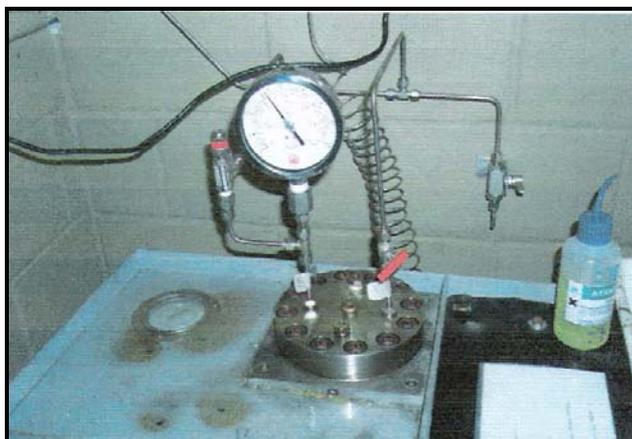
**Figura 3.2** - Autoclave (2L) utilizada no ensaio.
