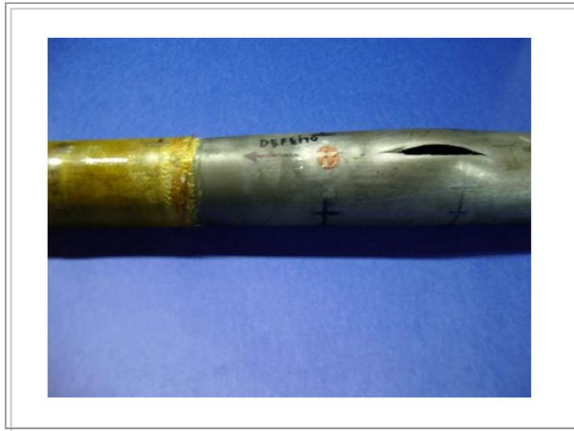
Figura A1. Tubo TPC 165 D após ensaio hidrostático
