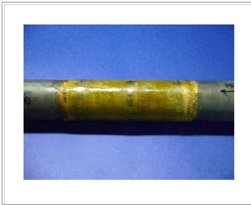
**Figura 52.** *Reparo do tubo TPC 165 D após ensaio hidrostático*
