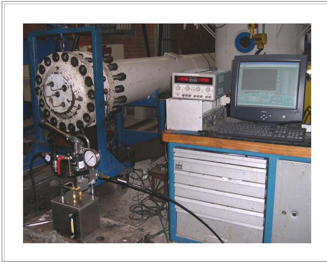
Figura 39. Bomba hidráulica e sistema de aquisição de dados
