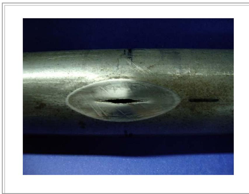
Figura 56. Tubo TPC 163 A após ensaio hidrostático
