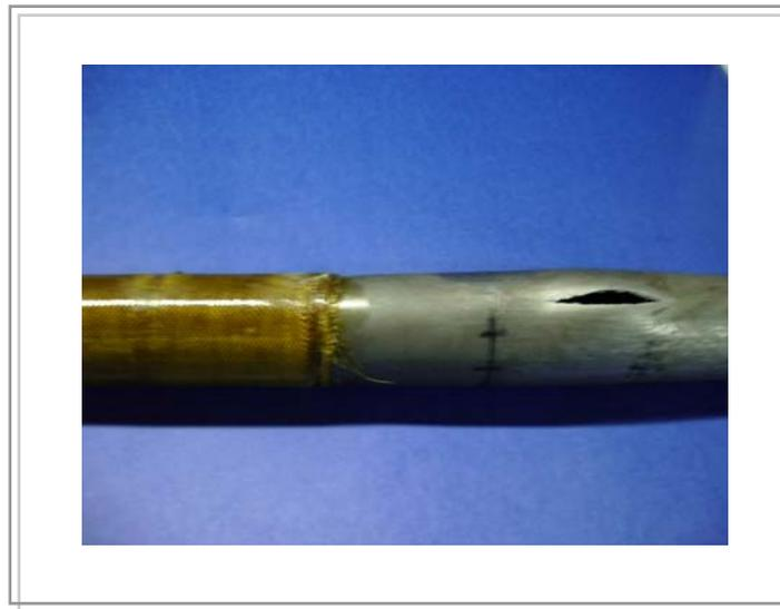
Figura 49. Ruptura do tubo TPC 165 E fora do reparo
