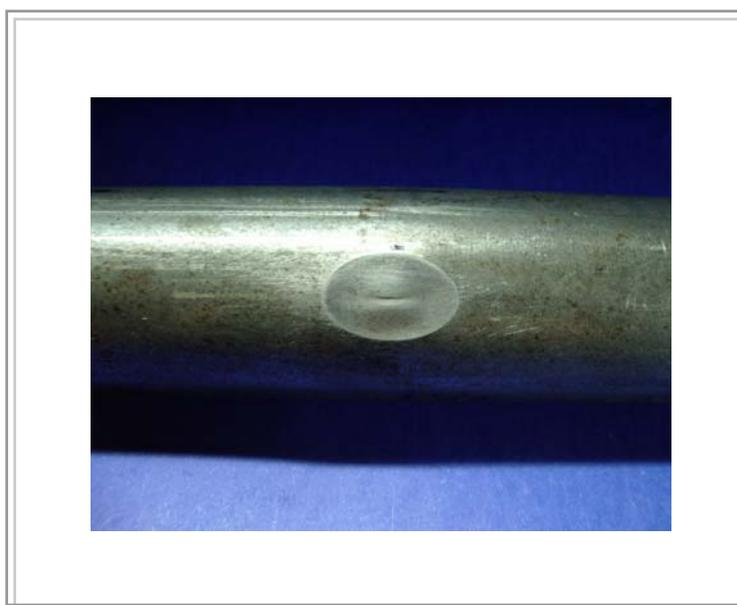
**Figura 42.** *Tubo TPC 163 D após ensaio hidrostático*
