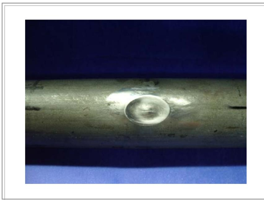
Figura 51. Tubo TPC 164 H após ensaio hidrostático
