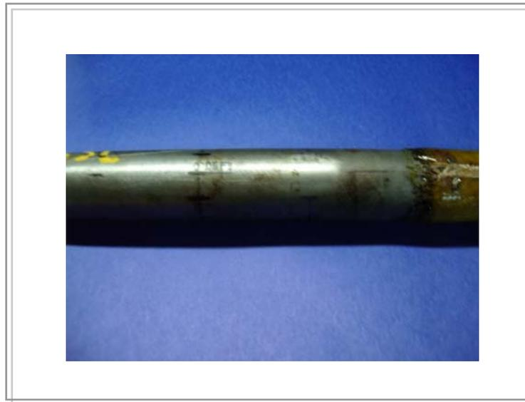
Figura 59. Abaulamento do tubo TPC 163 C fora do reparo
