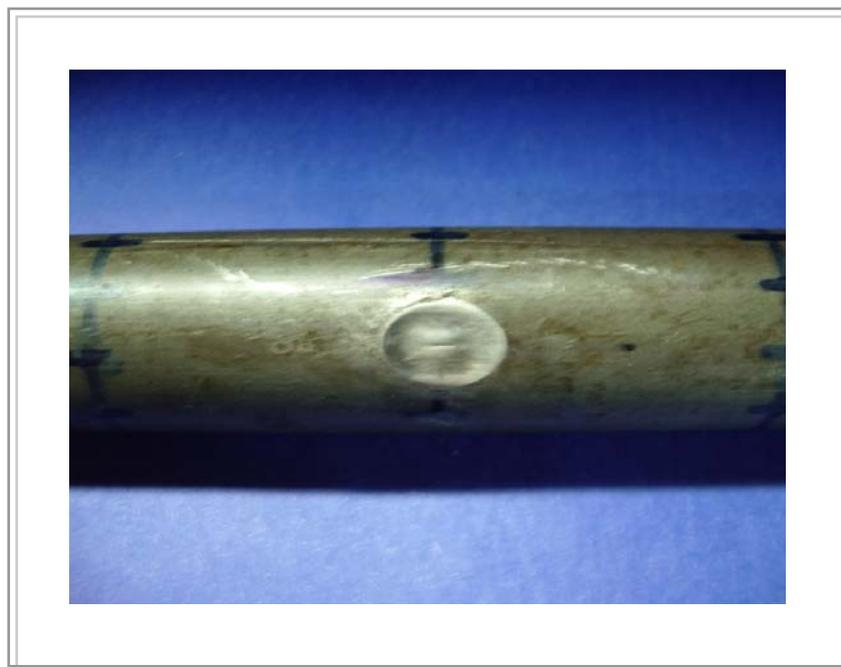
Figura 46. Tubo TPF 1B após ensaio hidrostático
