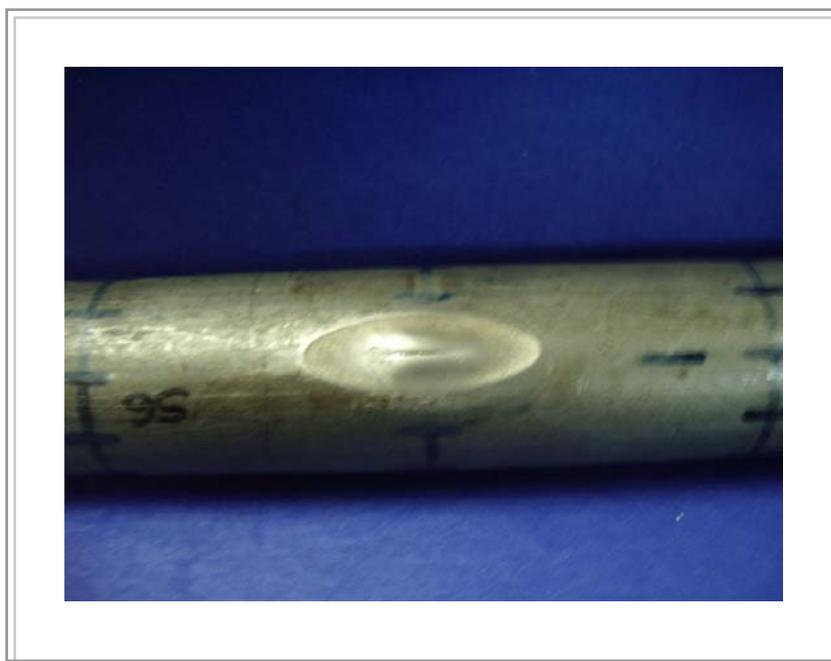
**Figura 61.** *Tubo TPC 164 E após ensaio hidrostático*
