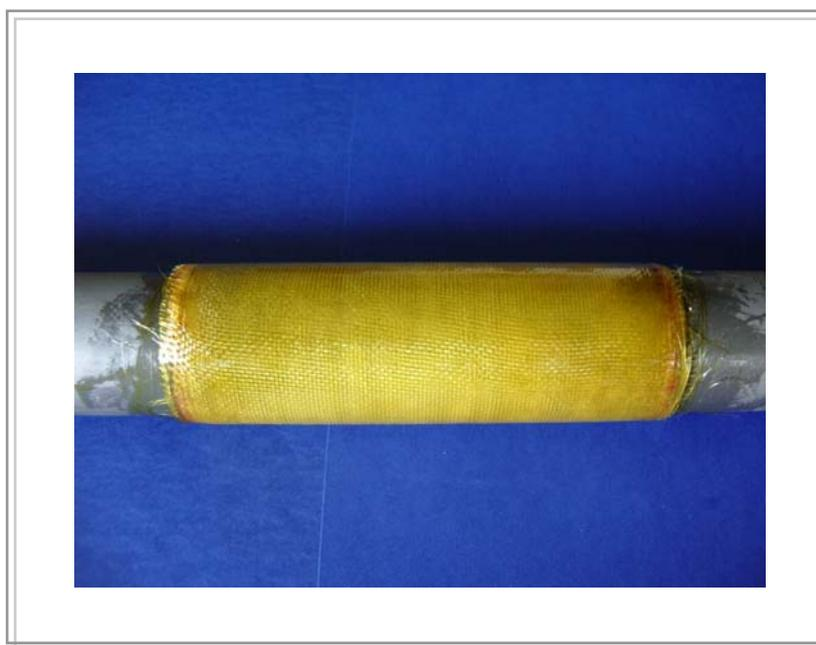
**Figura 25.** *Tubo com defeito reparado com material compósito*
