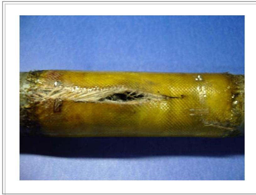
Figura A11. Tubo TPC 163 C após ensaio hidrostático
