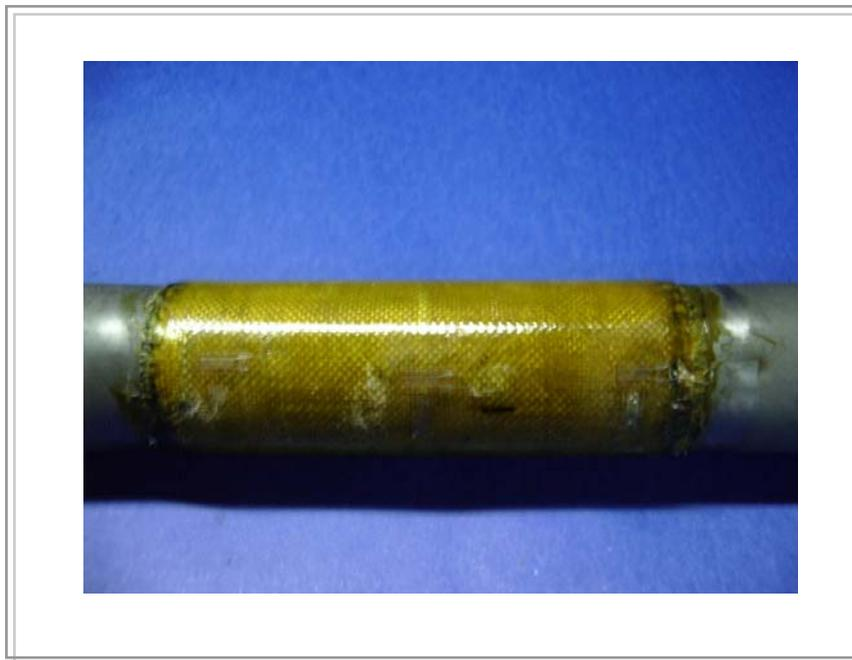
**Figura 62.** *Tubo TPC 164 G após ensaio hidrostático*
