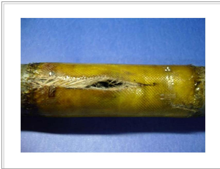
**Figura 57.** Ruptura do material compósito após ensaio do tubo TPC 163 C
