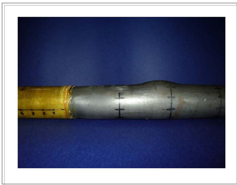
Figura 71. Ruptura do tubo TPC 164 G
