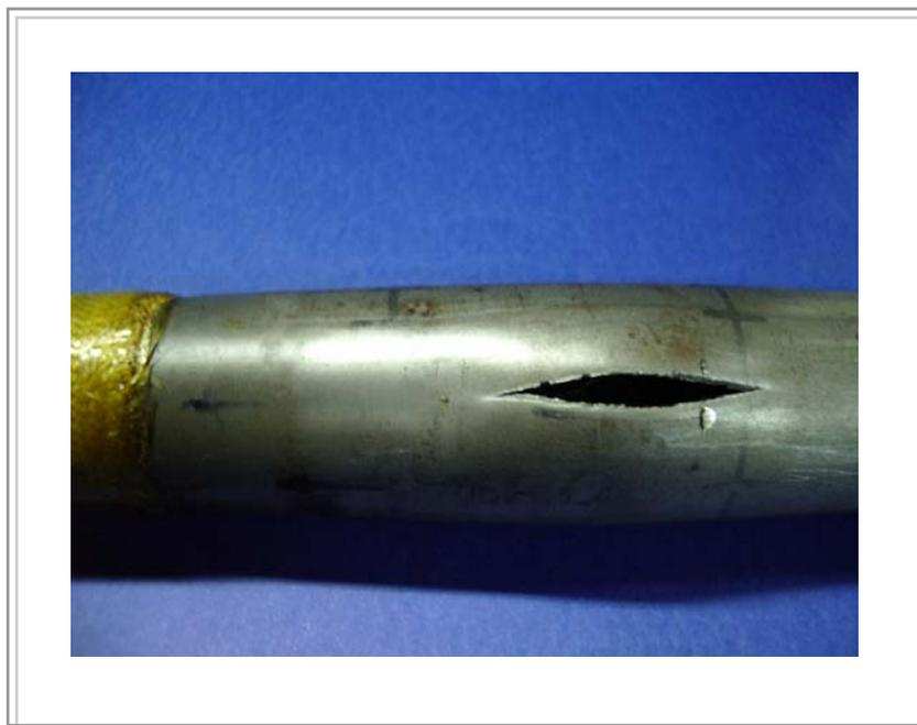
**Figura 68.** *Falha do tubo TPC 165 C fora do reparo*
