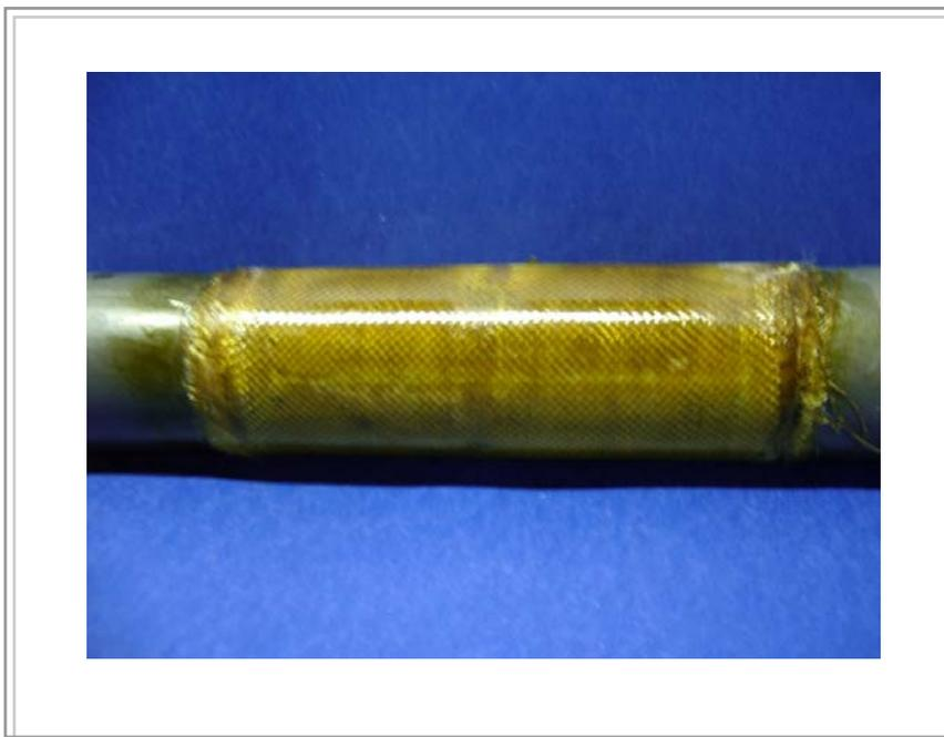
**Figura 47.** *Reparo do tubo TPC 165 E após ensaio hidrostático*
