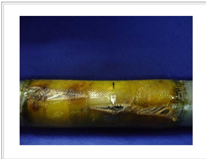
**Figura 43.** Ruptura do material compósito no tubo TPC 163 E após ensaio
