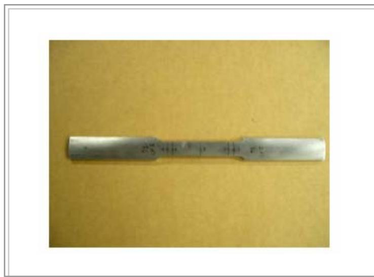
Figura 14. Corpo de prova usado no ensaio de tração
