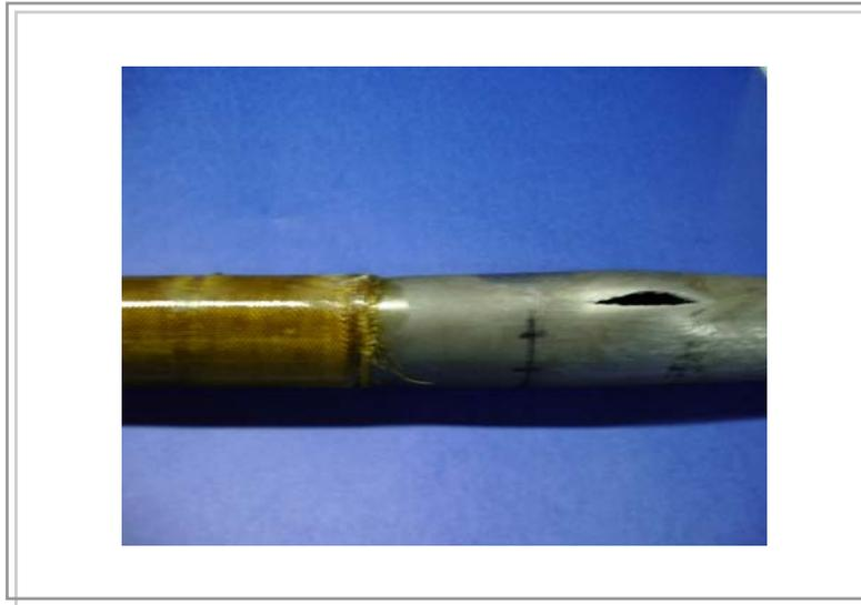
Figura A17. Tubo TPC 165 E após ensaio hidrostático
