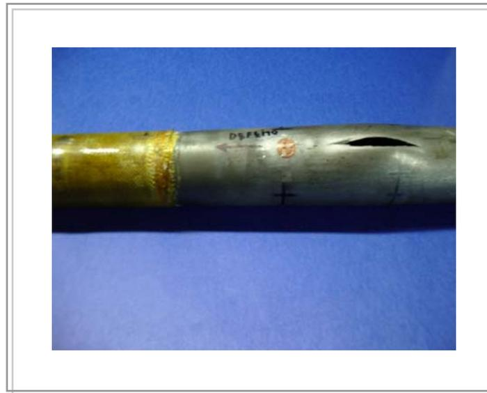
Figura 54. Tubo TPC 165 D com a falha do material fora do reparo
