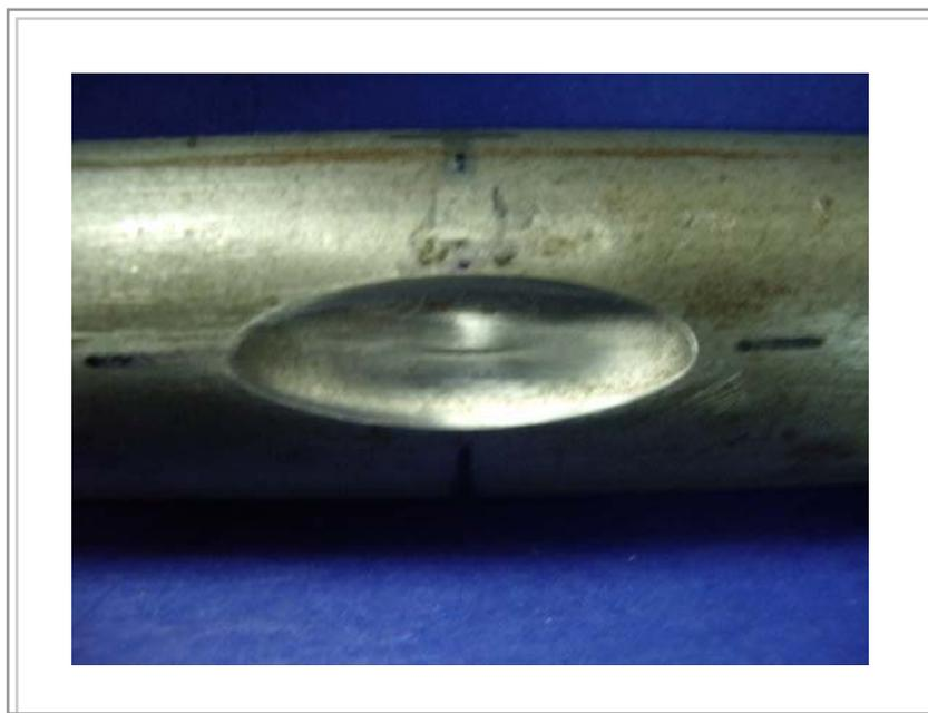
Figura 66. Tubo TPC 165 A após ensaio hidrostático
