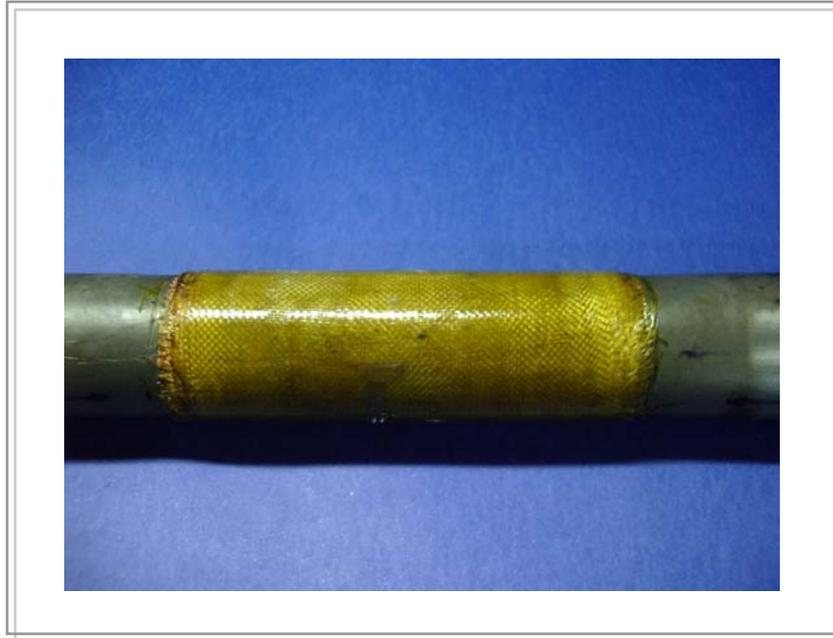
**Figura 67.** *Tubo TPC 165 C após ensaio hidrostático*
