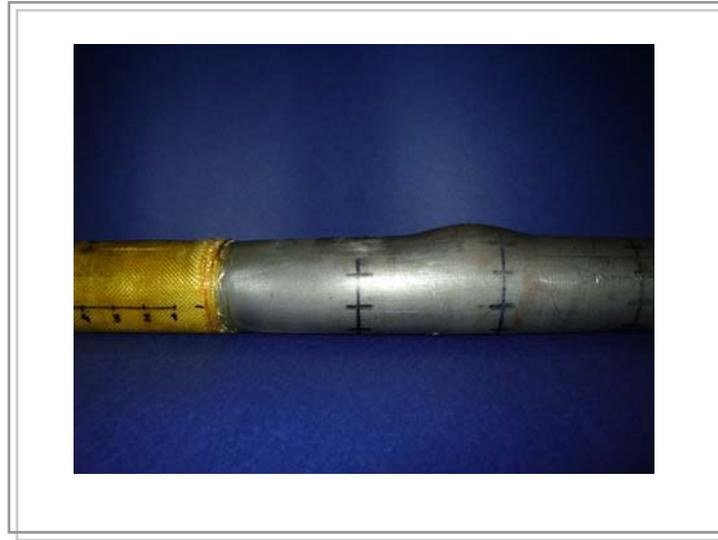
Figura 64. Abaulamento do tubo TPC 164 G na ruptura fora do reparo
