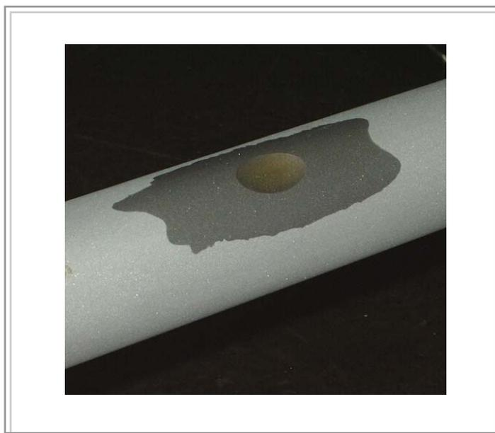
**Figura 24.** Defeito nivelado com material de enchimento
