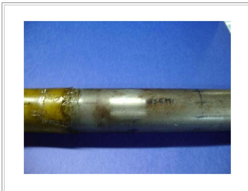
**Figura 58.** Abaulamento do tubo TPC 163 C fora do reparo
