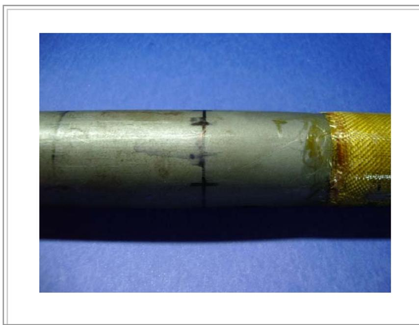
**Figura 53.** *Abaulamento do tubo TPC 165 D após o ensaio*
