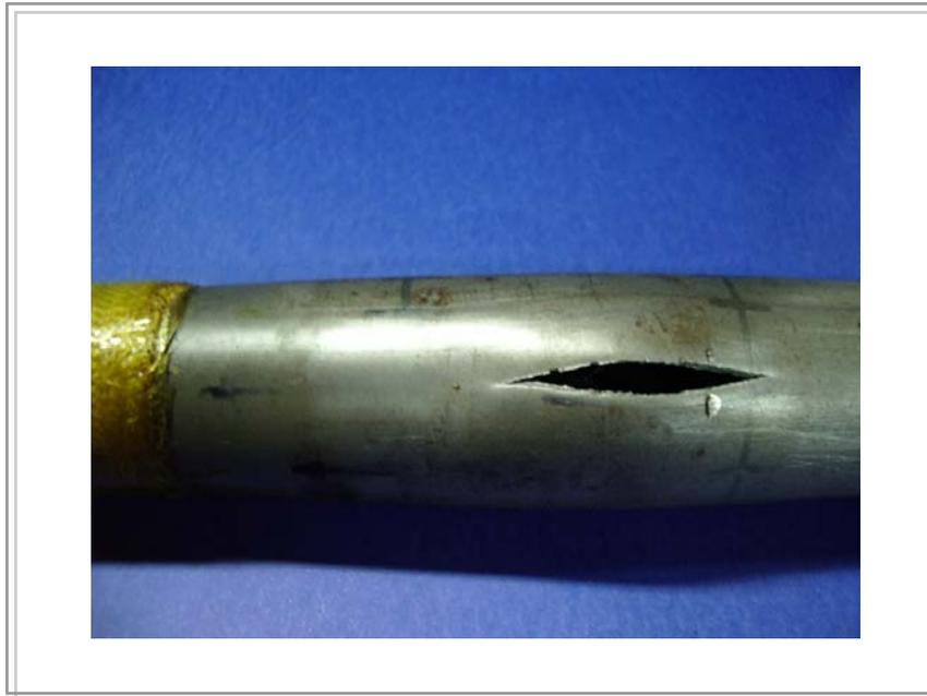
Figura A6. Tubo TPC 165 C após ensaio hidrostático
