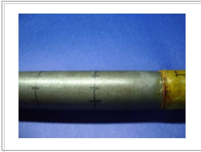
Figura 69. Abaulamento do tubo TPC 165 C após ensaio hidrostático
