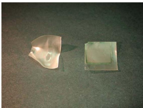
**Figura 4.19:** Fotografia do filme de amido não-recoberto 5MG (à esquerda) e do mesmo filme recoberto em ambiente de plasma de 1-buteno com uma camada de 30 nm (à direita) após o teste de absorção de água.
