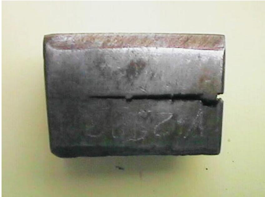
Figura 3 – Trinca pelo hidrogênio (stepwise cracking) ocorrido em vaso de alta pressão da área de tratamento de gases.
