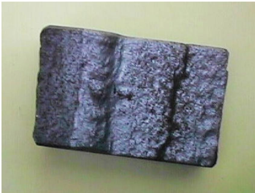
Figura 7 – Corrosão sob tensão em meio básico ocorrido na alta pressão da DEA pobre.
