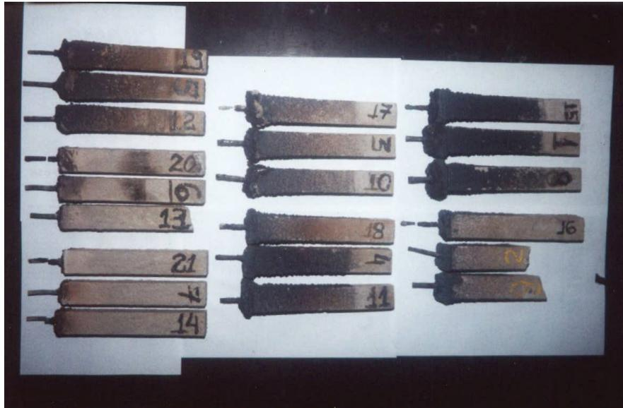
Figura 38: Aspecto das amostras após o teste de corrosão. Algumas amostras se partiram pelo fato de terem sido fortemente desgastadas.
