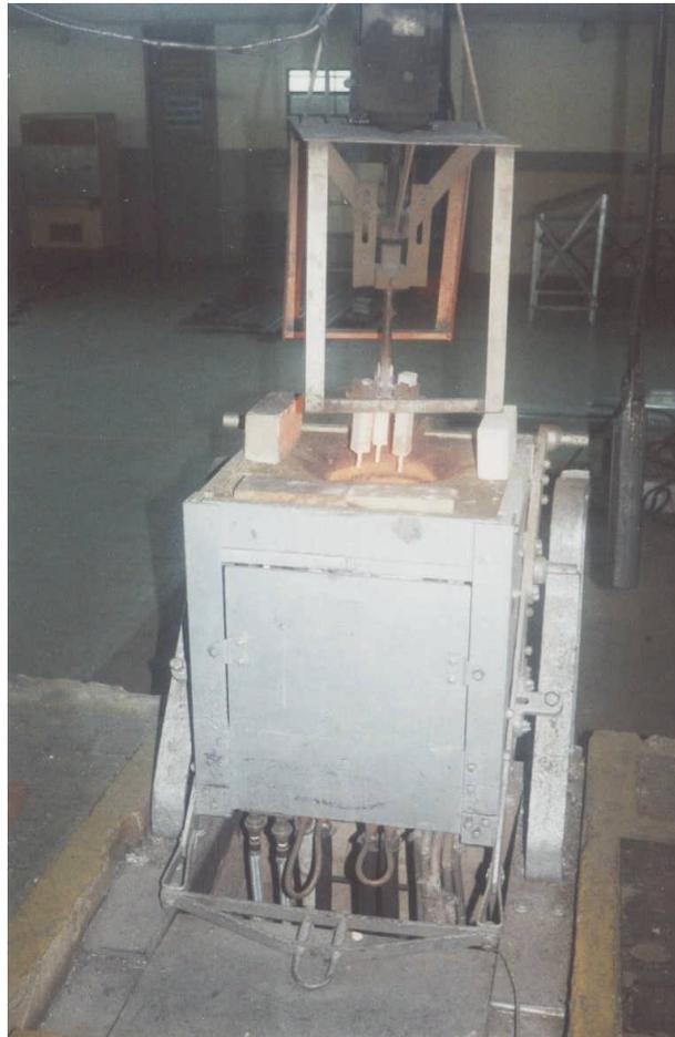
Figura 21: Equipamento usado no teste de corrosão (Finger Test) onde o material testado é posto em contato com ferro gusa e escória de alto-forno. Embaixo pode ser visto o forno de indução e em cima a estrutura de fixação das amostras que giram dentro do banho.
